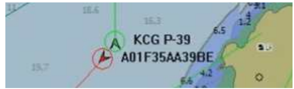
그림 2. AIS의 초기 설정 값 오류 Fig. 2. Initial value error in AIS
