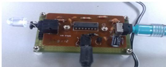
그림 2. 오디오 채널 전송부 시스템 구성도
