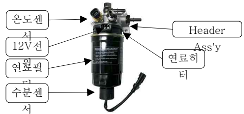
Fig. 2. Design diagram of composited fuel heater 그림 2. 통합형 연료필터 조립도
