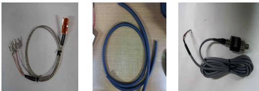
Fig. 5. Temperature sensor, Horse for fuel, pressor sensor 그림 5. 온도센서, 연료용 호스, 압력센서
