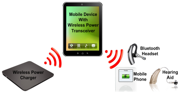
그림 1. 기기간 무선 전력 전송을 위한 무선 전력 송수신기
