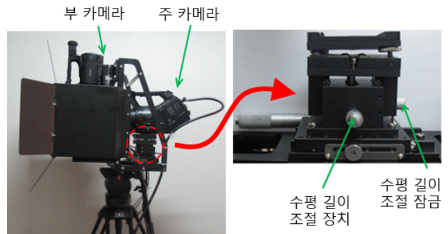
그림 2. 주-부 방식 스테레오 카메라 시스템 Fig. 2. Main-sub type stereoscopic camera system.
