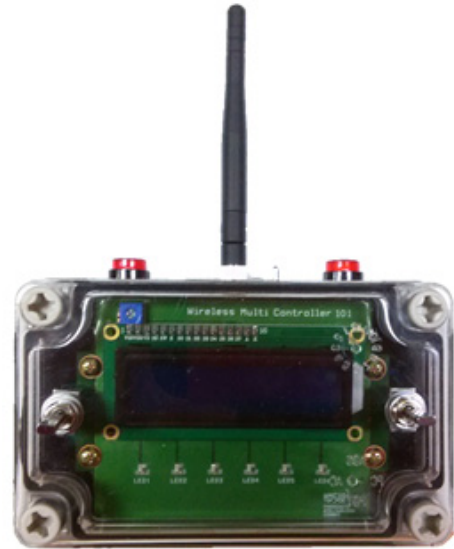
그림 6. 무선 데이터 수집 장치의 모습 Fig. 6. Wireless data gathering device.
