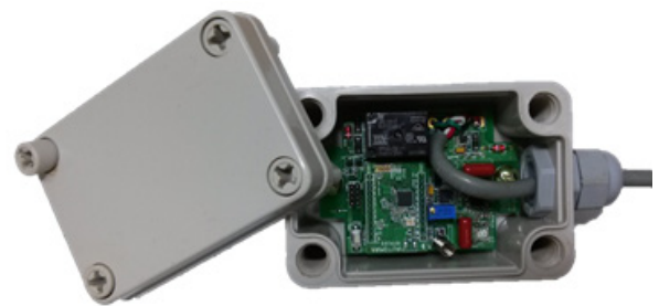
그림 4. 개발한 음파 검출 무선 센서의 모습 Fig. 4. Developed wireless sensor for the sound wave detection.
