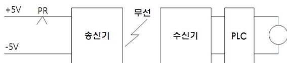
그림 4. 무선 데이터 송수신 시스템 구성 방법 Fig. 4. Configuration of wireless data transmission system
