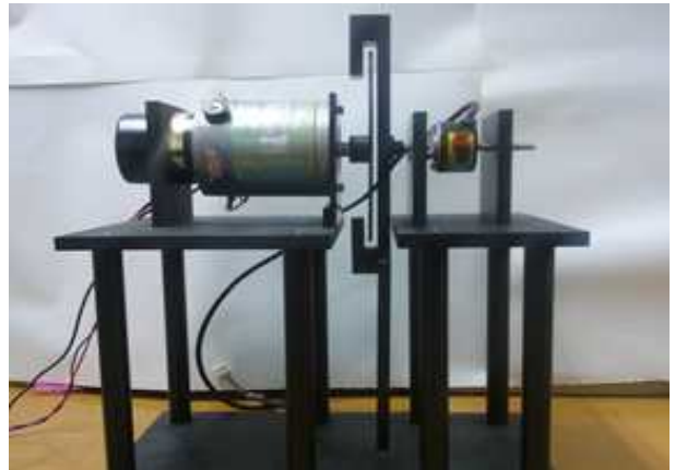
그림 12. 제작된 아라고 원판 시스템 Fig. 12. A experimental Arago's Disk system
