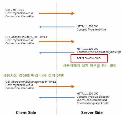
그림 5. 정상적인 웹 통신 흐름 Fig. 6. Normal web traffic flow
