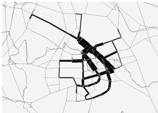
<그림 7> 전주시 시내버스 교통약자 수요 분석결과 <Fig. 7> Analysis of Transit Volume of Jeonju City Buses
