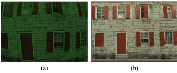
그림 12. 제안하는 배럴 왜곡 보정 프로세서를 통한 보정 결과 예시: (a) 왜곡된 베이어 패턴의 이미지, (b) 보정한 컬러 이미지
