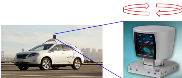
그림 1. 파노라믹 스캔 라이다 시스템의 한 예 [2] Fig. 1. Example(Velodyne) of a PSL system.
