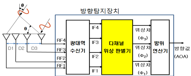
그림 1. 트리플 베이스라인 인터페로미터 방향 탐지 장치 Fig. 1. Direction finding equipment using triple baseline interferometer.
