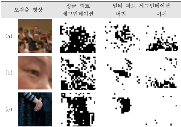
그림 6. 오검출 영상의 멀티 파트 세그멘테이션 예시 Fig. 6. Examples of multi-part segmentation for false positive samples.
