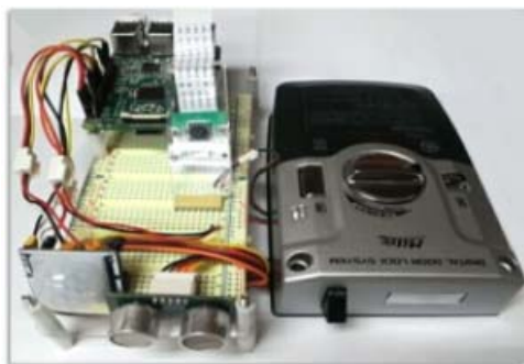
그림 4. 스마트 도어록 구성도 Fig. 4. Smart Door lock system configuration with raspberry pi
