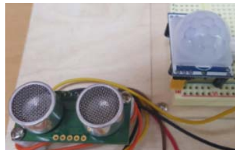
그림 6. 사람을 감지하기 위한 초음파 센서와 인체감지 센서 Fig. 6. PIR sensor and ultrasonic sensor for detecting people
