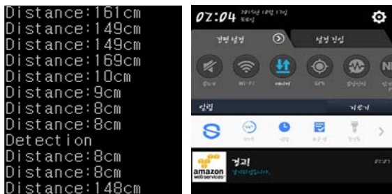
그림 9. (좌) 초음파 센서에서 측정된 값 (우) 사용자에게 경고 푸시 알림 Fig. 9. (left) Measured value of the ultrasonic sensor (right) Warning push notification for user
