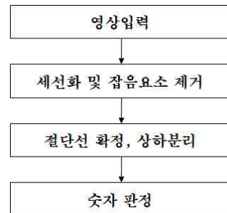
그림 2. 제안된 숫자인식 알고리즘의 순서도 Fig. 2. The Flow for the proposed algorithm
