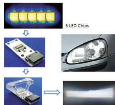
〈그림 15〉 Multi-chip 패키징을 이용한 자동차 전조등 (출처:Osram)
