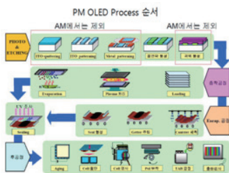
〈그림 9〉 PM OLED 공정 순서
