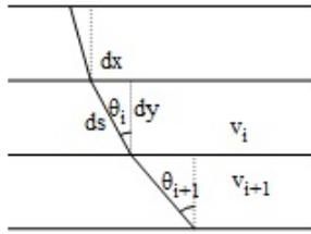
Figure 4. The refraction path of the light ray through multiple layers of media of different densities; 밀도가 다른 여러 겹의 매질을 통과하는 빛의 굴절경로
