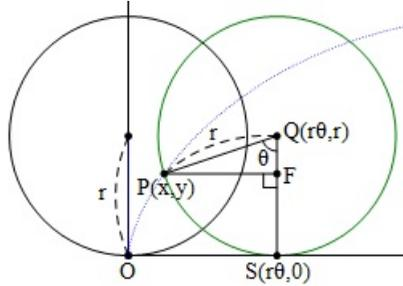
Figure 2. Parametric expressions of the cycloid curve; 사이클로이드 곡선의 매개변수 표현
