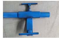
(d) Welding Jig
