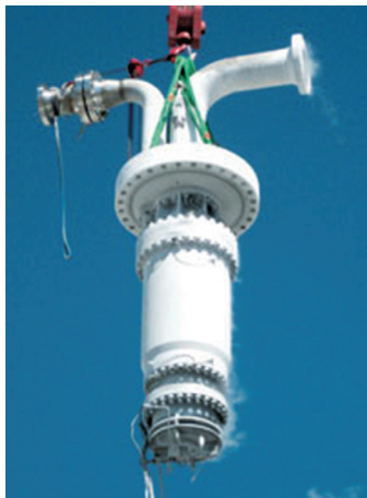
[그림 8] LNG 펌프
