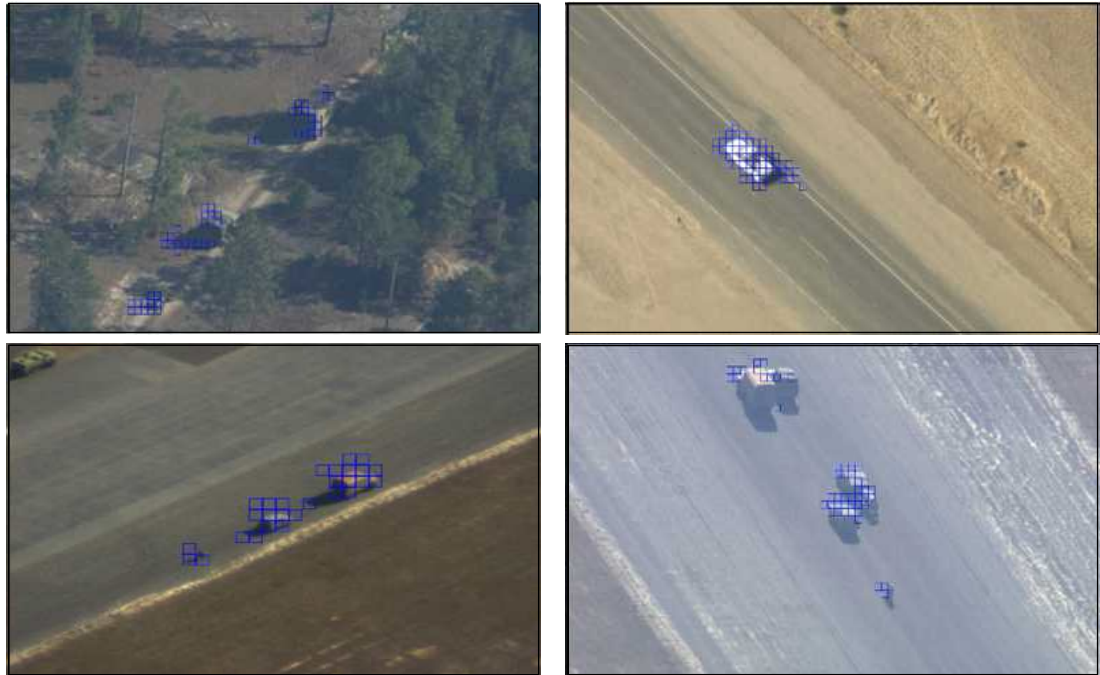
그림 12. 움직임 벡터와 시공간적 중요도 지도를 활용한 주요 움직임 객체 탐지 및 추적 결과 Fig. 12. Moving object detection and tracking using motion vector and spatiotemporal saliency map
