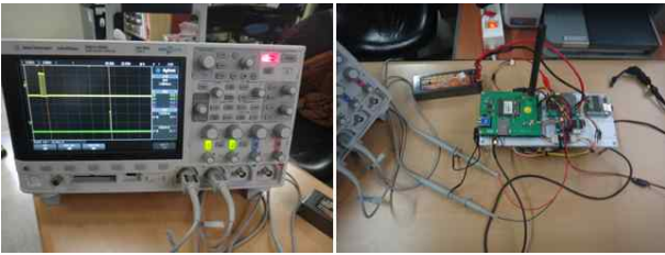
그림 8. 지연시간 측정을 위한 오실로스코프와 네트워크 modem Fig. 8. The Oscilloscope and network modem for delay time test.
