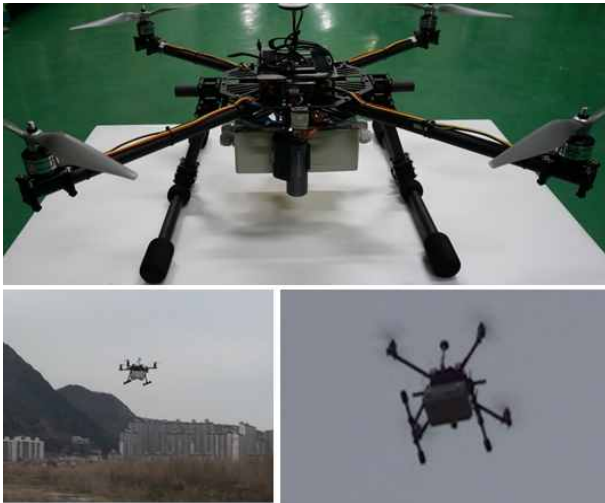
그림 11. 쿼드-로터 형태 UAV(위)와 비행 테스트(아래) Fig. 11. Quad-rotor type UAV(Up) and flight test(down).
