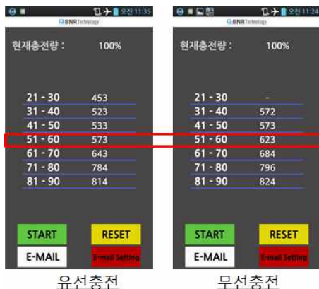
그림 10. 제작한 충전시간 측정 앱. Fig. 10. Application program for charging time
