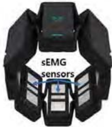
〈그림 7〉 MYO armband
