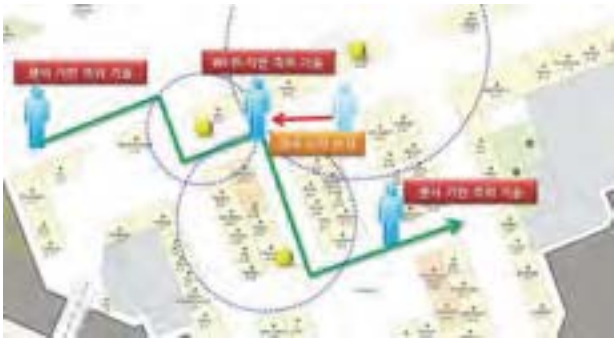
〈그림 8〉 센서와 Wi-Fi를 이용한 융합 측위 기법
