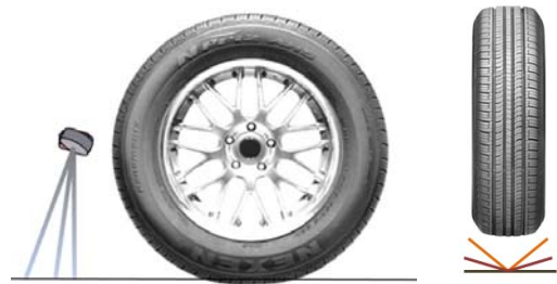
Fig. 2. 공기 분사 실험 변수: 공기 분사 노즐 설치 방법(좌) 및 노즐 형상 (우)
