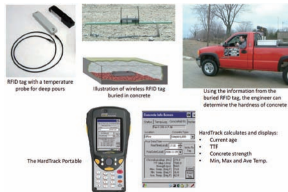
그림 6. RFID기반 무선 콘크리트 모니터링 시스템의 예 6,7)
