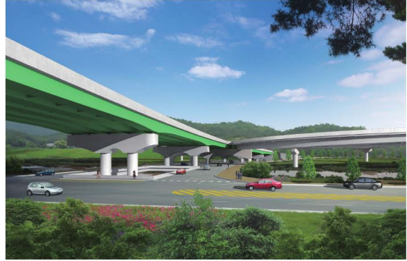
그림 5. STEEL BOX GIRDER교(팔거고가교) 조감도
