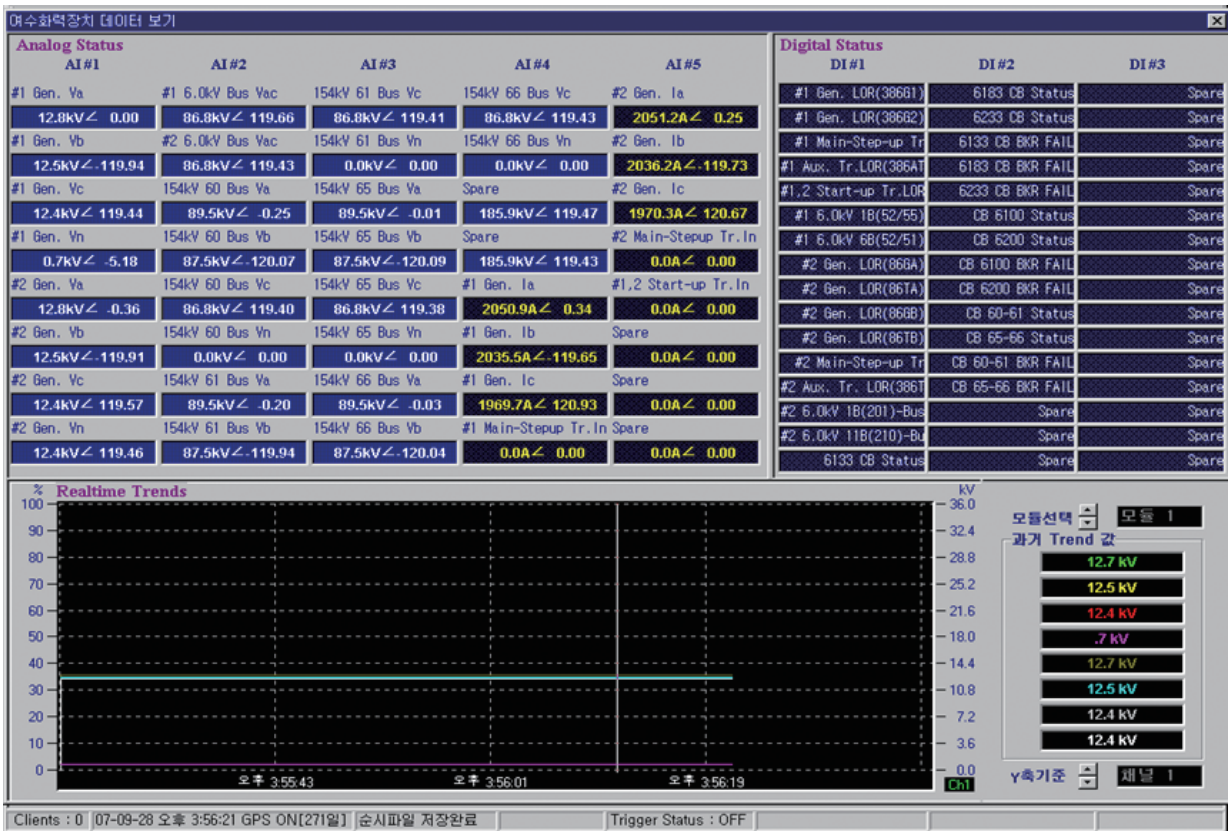
그림 2. (주)프로컴 사의 계통현상 감시·기록 장치 'PSDM-TS'의 기록 데이터 출력화면 예시 (출처 : (주)프로컴 사의 제품 소개자료)
