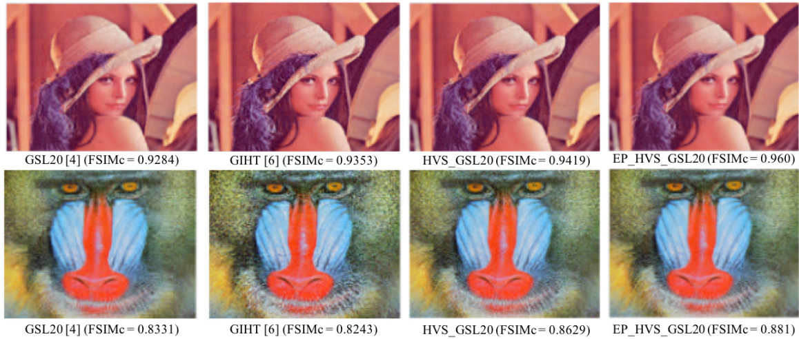
그림 2. 측정율 0.2, 블록크기 32x32에서 복원된 Lena 및 Mandrill 영상 Fig. 2. Reconstructed Lena and Mandrill images at sub-rate 0.2, block size 32x32.
