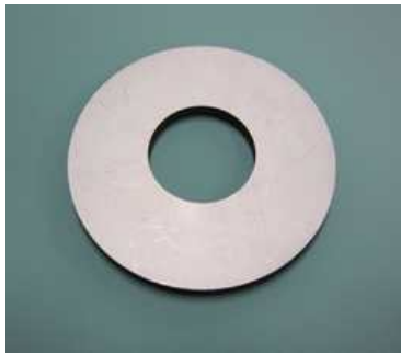
Fig. 2 Piezoelectric element (outer dia.: 5 cm, inner dia.: 2 cm, t: 0.5 cm)
