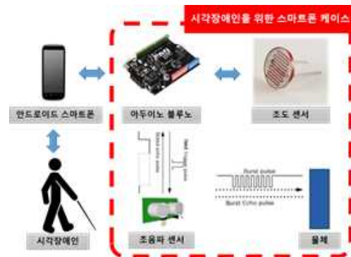
그림 2. 스마트폰 케이스의 전체 흐름도 Fig. 2 Overall flow of Smartphone case for blind
