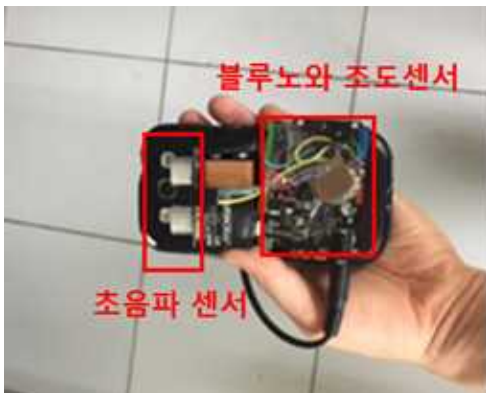
그림 3. 시각 장애인을 위한 스마트폰 케이스 구현 Fig. 3. Implementation of Smartphone case for blind
