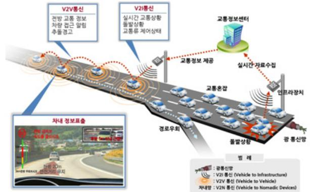
그림 1. V2I와 V2V 기반 도로의 자동차 협업 서비스 시스템 (출처 : 국토해양부)
