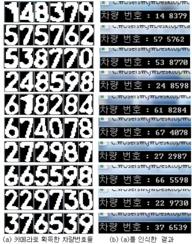
그림 20. Template Matching을 이용한 번호 인식 결과
