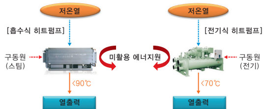
[그림 2] 흡수식 히트펌프와 전기식 히트펌프 개념도
