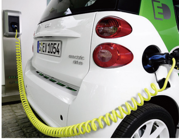
그림 1 : 전기자동차 충전 케이블과 충전 플러그 Type 2
