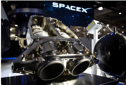
Fig. 8. Super Draco engine[16]
