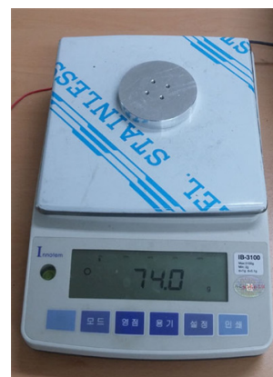
그림 4. 원판의 무게 Fig. 4. Weight of the rotor
