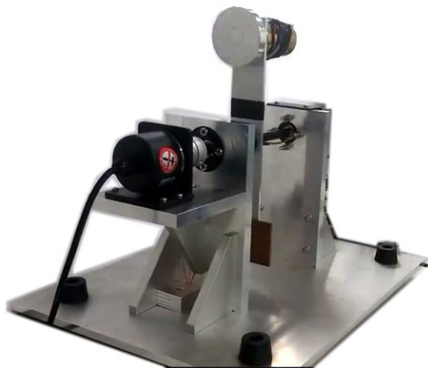
그림 9. 원판의 반작용을 이용하여 안정된 역진자 Fig. 9. Stabilized reaction wheel inverted pendulum
