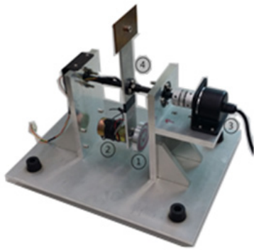
그림 1. 원판 반작용을 이용한 역진자 시스템 Fig. 1. System of a reaction wheel inverted pendulum
