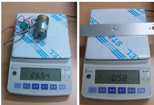
그림 3. 모터와 링크의 무게 Fig. 3. Weight of the motor and link
