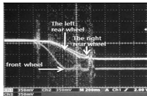
그림 15. 부하시 좌측으로 45도 조향 출력 파형 Fig. 15. Waveform of steering angle while steering from 0 degree to right 45 degree with load weight
