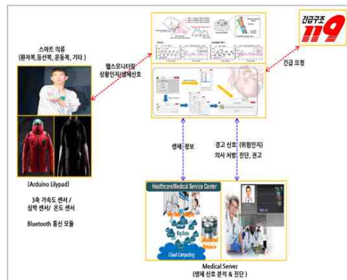
그림 1 스마트 의류를 이용한 유-헬스케어 시스템 전체 구조 Fig. 1. The Whole Architecture of U-Healthcare System using Smart-Cloth
