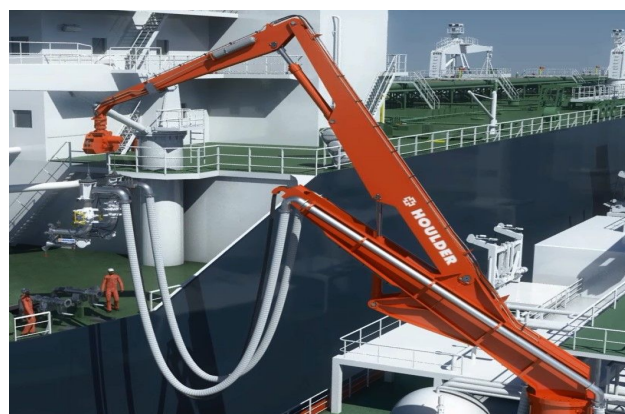
Fig. 3. LNG Bunkering Hose (ABS, 2015).
