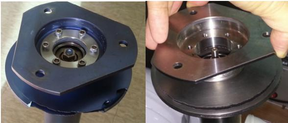
**Fig. 11** Broken membrane
