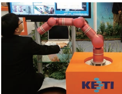
〈그림 16〉 국내 KETI에서 개발된 다관절 로봇의 사례
