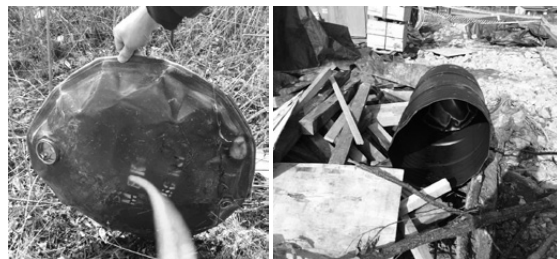
화목난로용 페드럼통 용단작업 중 폭발로 1명 사망 ('13.1.24, 충북 영동)
