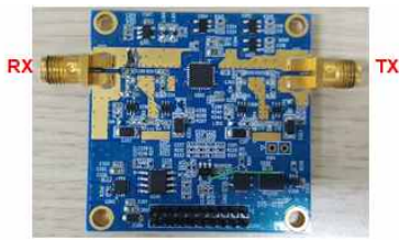
그림 6. UWB 센서부의 하드웨어 구현 결과 Fig. 6. Hardware Implement result of the part of UWB sensor
