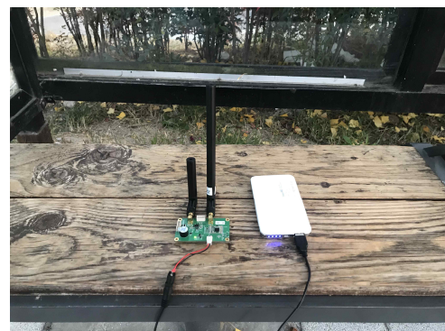
그림 5. 수신기의 승강장 배치 사진 Fig. 5. Receiver installation photo at bus stop.
