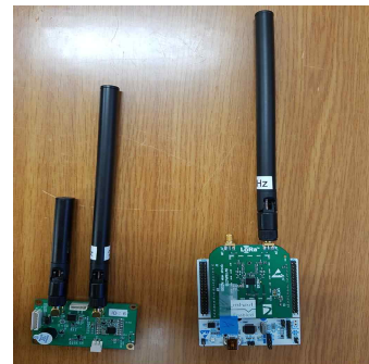
그림 4. 버스 진입 알림 시스템의 송신기와 수신기 Fig. 4. Transmitter and receiver of bus entry notification systems.
