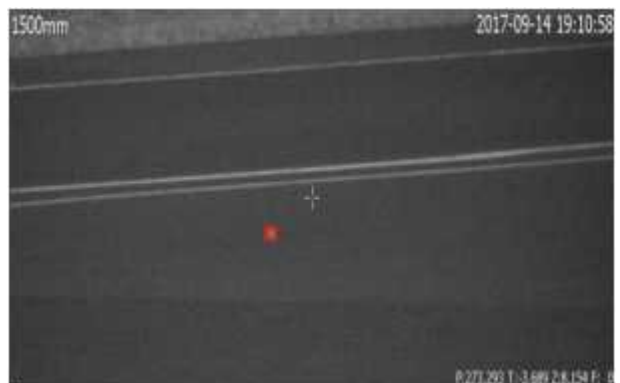
그림 6. 야간 IR카메라 1500mm FOD 탐지 Fig. 6. IR camera 1500mm FOD detection night test.
