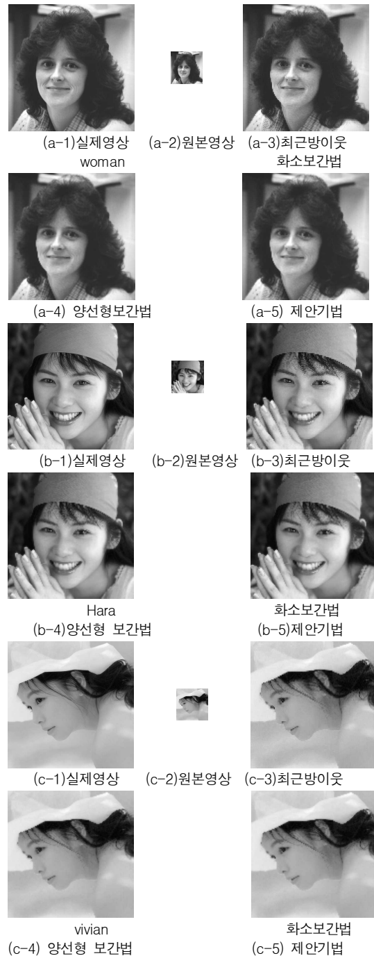
그림 4. 기존 기법 및 제안 기법을 적용하여 원본 영상을 x축, y축 방향으로 각각 4배 확대한 영상 Fig. 4. 4-times magnified image using the previous schemes and the proposed scheme
