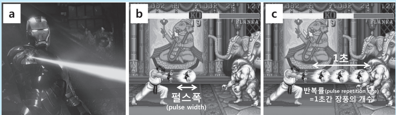
그림 1 (a) 연속발진레이저의 예; (b) 펄스레이저 펄스폭의 비유; (c) 펄스레이저 반복률의 비유
