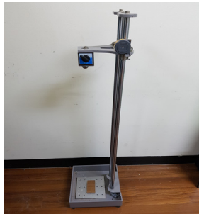
Fig. 3. 충격하중시험(Steel ball falling impact test).
